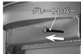
いずれの場合も灰は炉床に2cm程度残り、グレートレバーを押し、グレートを開めた状態にします。灰受けボックスの中に灰が8割程度溜まったら安全に処分してください。
