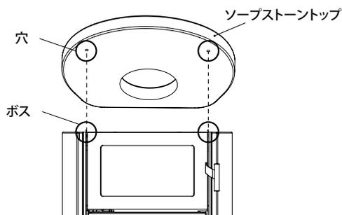
ストーブトップをストーブに取り付ける際、下の面にある2つの穴がストーブ本体の位置決めボスに入るようにしてください。
