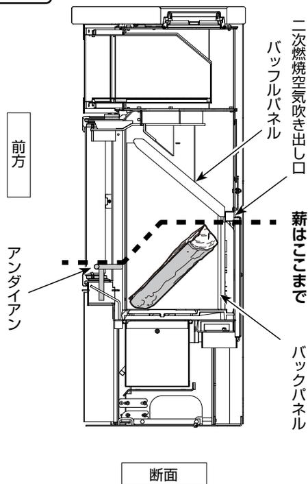
薪を燃焼室上部のバッフルパネルに当たるまで入れないでください。薪の投入量は燃焼室奥にあるバックパネル上部の二次燃焼空気吹き出し口より下まで、なおかつ燃焼室入り口にあるアンダイヤンを超えて落ち出ない高さにしてください。薪がくすれてガラスに当たらないように注意してください。
